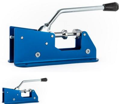
L'Estrattore Roll-Line® è perfetto per l'operazione di inserzione e rimozione delle ruote. L'estrattore può essere allo stesso tempo portato nel trolley o montato su un banco di lavoro. Può essere utilizzato con ruote fino a 70mm di diametro e con cuscinetti da 7 o 8mm. Grazie al suo gancio posteriore, l'estrattore può anche essere utilizzato per rimuovere i cuscinetti. Per maggiori info, visionare il video tutorial.
